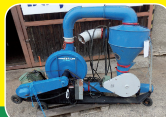
Pneumatický dopravník zrnin Kongskilde SUC 150E výkon 8 t/hod., v ceně stroje je kabel, 6 m trubek, kolena, sací hadice, sací hlava a spony Cena: 136 000,- Kč + DPH
