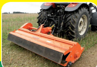
Mulčovač PERFECT KT-270 předváděcí záběr 2,7 m, velká kladiva 2,2 kg, kardan se spojkou, hydraulický boční posun, ideální i do kukuřice Cena: 189 900,- Kč + DPH
