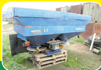
Rozmetadlo Bogballe EX objem 1900 l, záběr 12-36 m, hydraulické ovládání, kardan, lopatky, síta, libela, pěkný stav od SHR cena 55 000,- Kč + DPH
