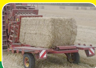
Akumulační vozík pro velké hranolovité balíky kompatibilní s lisy Hesston, N. Holland, Case, Krone atp., verze CZ = bočnice zasunovatelné pro úzký transport cena 125 000,- Kč + DPH
