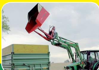
Vysokovýkloná lopata a transportní bedna zároveň - Samuraj šířka 160 až 250 cm, vyměnitelné ostří, pro 3-bodový závěs, na Euro úchyt čelního nakladače, překlopná výška až 5 m Cena: 53 000 - 120 000,- Kč + DPH
