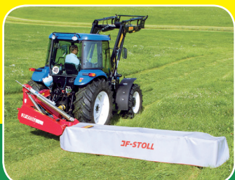
Žací stroj JF-STOLL SM 3205, záběr 3,2 m, diskový, kardan, sklápění hydro, rychlovýměnné nože, nový, cena 180 000,- Kč.
