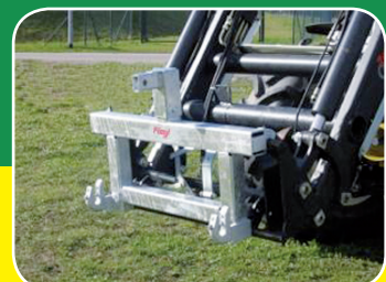
Přechodový díl nářadí do tříbodového závěsu, do čelního nakladače s Euro úchytem se dá agregovat nářadí z 3. bodového závěsu, nový, cena 11 000,- Kč.
