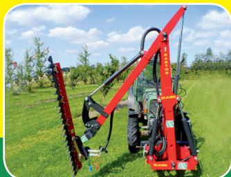
Rám pro ořezávací nářadí Elkaers, předváděcí, model HK Castor, pro kotoučovou pilu HS1750 nebo ořezávací kleště, výškový dosah s pilou 5 m, boční dosah 3 m, schopnost práce vpravo i vlevo od traktoru, cena 190 000,- Kč.
