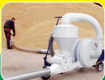
Pneumatický dopravník obilí SUC 200E, saje + tlačí obilí až na 200 m, výkon až 15 t/hod., elektrický pohon, nový, cena 180 000,- Kč
