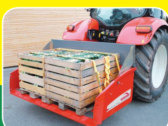
Vysokovýklopná lopata a transportní bedna zároveň - Samurai, šířka 160 až 250 cm, pro 3. bodový závěs, úchyt pro čelní nakladač, překlopná výška až 5 m, cena 53 000,- až 120 000,- Kč.
