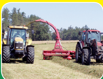
Tažená řezačka JF-FCT 1100, sběrač 2,1 m, buben 30 nožů, pro traktory 110-200 PS, pěkný stav, cena 290 000,- Kč.
