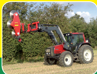
Ořezávací pila Elkaers s rámem na čelní nakladač, záběr 175 cm, na větve do 15 cm silné, cena 325 000,- Kč
