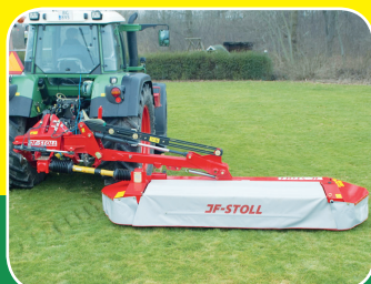
Žací stroj JF-STOLL GX5 3205, záběr 3,2 m, bez kondicionéru, středové zavěšení, diskový, rychlovýměnné nože, hydraulické odpružení, hydraulická nárazová pojistka, kardan, nový, cena 240 000,- Kč.
