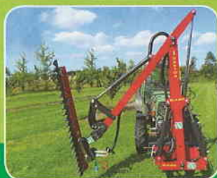
Rám pro ořezávací nářadí Elkaers , předváděcí, model HK Castor, pro kotočovou pilu HS1750 nebo ořezávací kleště, výškový dosah s pilou 5 m, boční dosah 3 m, schopnost práce vpravo i vlevo od traktoru cena 190.000,- Kč
