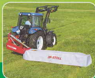
Žací stroj JF-STOLL SM 3205 , záběr 3,2 m, diskový, kardan, sklápění hydro, rychlovýměnné nože, nový cena 180.000,- Kč
