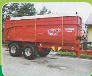
Návěs Krampe BB750 , předváděcí, objem 40 m 3 , tonáž 23 tun, extra široké pneu 710/50R26,5, nucené řízení náprav, plachta + můstek, r.v. 2014 cena na dotaz
