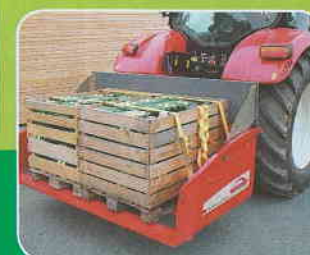
Vysokovýklopná lopata a transportní bedna zároveň - Samurai , šířka 160 až 250 cm, pro 3. bodový závěs, úchyt pro čelní nakladač, překlopná výška až 5 m cena 53.000,- až 120.000,- Kč
