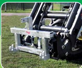
Přechodový díl nářadí do tříbodového závěsu , do čelního nakladače s Euro úchytem se dá agregovat nářadí z 3. bodového závěsu, nový cena 11.000,- Kč
