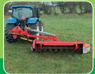
Žací stroj JF-STOLL GXS 3205 , záběr 3,2 m, bez kondicionéru, středové zavěšení, diskový, rychlovýměnné nože, hydraulické odpružení, hydraulická nárazová pojistka, kardan, nový cena 240.000,- Kč
