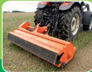
Mulčovač Perfect KT-270 , předváděcí, prac. záběr 2,7 m, zadní, s bočním posuvem, kladiva 2,2 kg, kardan se spojkou cena 206.800,- Kč
