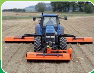
Mulčovač Perfect KX-860 , předváděcí, prac. záběr 8,6 m, trojkombinace, lze mít vše vzadu, kladiva 2,2 kg zajímavá cena na dotaz
