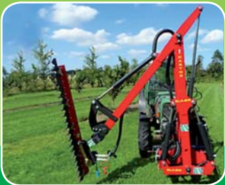
Rám pro ořezávací nářadí Elkaers , předváděcí, model HK Castor, pro kotoučovou pilu HS1750 nebo ořezávací kleště, výškový dosah s pilou 5 m, boční dosah 3 m, schopnost práce vpravo i vlevo od traktoru cena 190.000,- Kč
