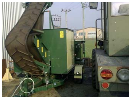
Drtič bioodpadů, které jsou v BPS také zpracovávány.
