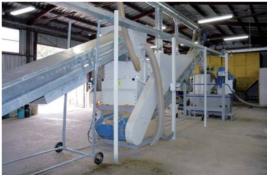
Linka na výrobu pelet v Březovicích. Kapacita linky s jedním granulátorem je v závislosti na druhu vstupní suroviny a provozní době 5 až 15 tisíc tun paliva za rok.
