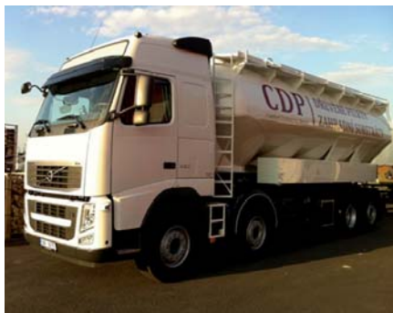
Pelety je možné dnes dopravovat i komfortně cisternou až do zásobníku (foto: CDP).
