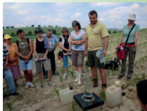
Ing. Václav Kadlec, Ph.D., pracovník VÚMOP předvádí laboratorní simulátor deště Kamphorst, pomocí kterého je možné simulovat určitou intenzitu deště a měřit odplavování ornice na určitém svahu.
